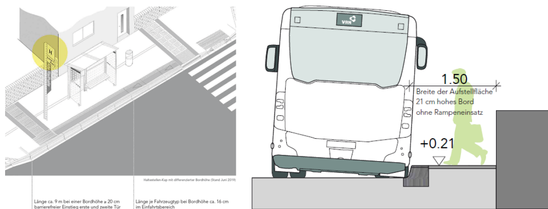
Abbildung 26: Aufbau barrierefreier Bushaltestellen und Mindestbreite des Gehwegs 24
